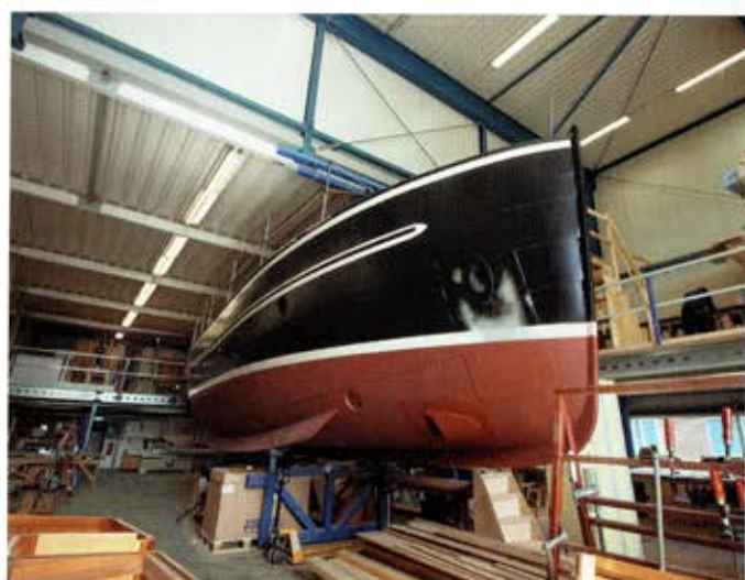
DROOGVALLEN KAN OP DE KIELBALK, KIMMIEKEN EN DИКE BODEMPLATEN.
